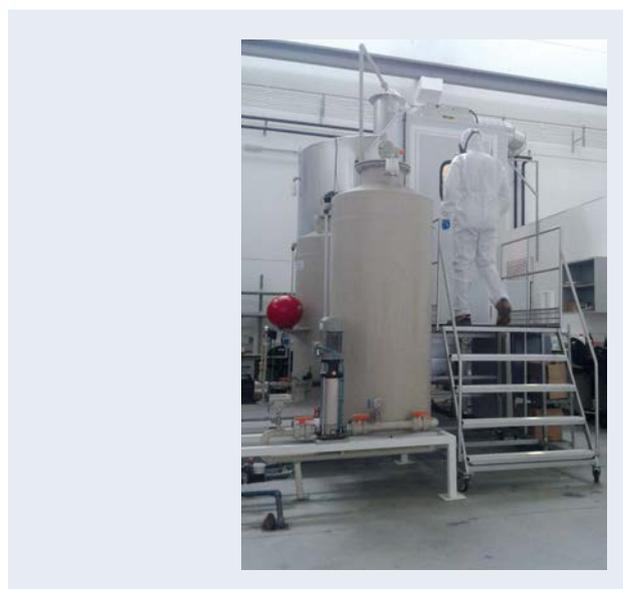
**Figura 8.4.** Cámara de acero inoxidable de 13 m<sup>3</sup> diseñada para la realización de estudios de exposición y dispersión de nanomateriales con sistema de autolimpieza dual integrado.
