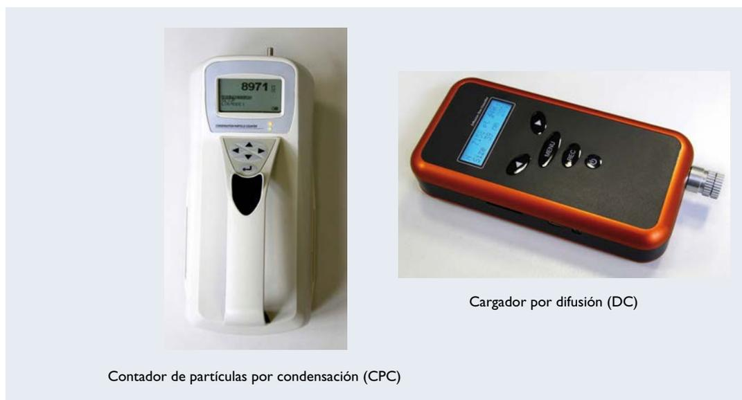
**Figura 8.1.** Ejemplos de equipos portátiles
